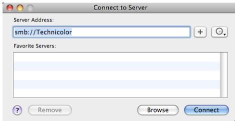
Na caixa **Endereço do servidor**, digite **smb://<nome do servidor>**, em que <nome do servidor> é o nome do servidor que forneceu (por defeito: **smb://Technicolor**).
