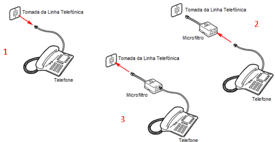
FIGURA 1. Instalação do Microfiltro
