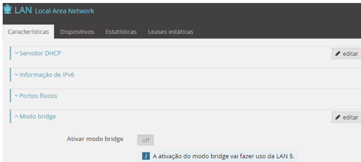
Figura 4-15: LAN ( Local Area Network ) – Características: Modo bridge
